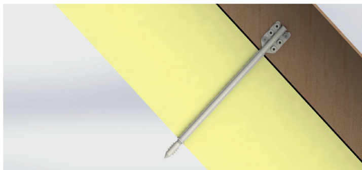
1. Fixer la suspente sur la charpente
