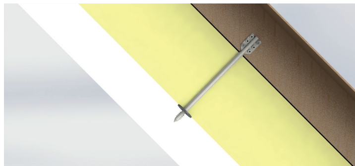
2. Positionner le contre-joint
