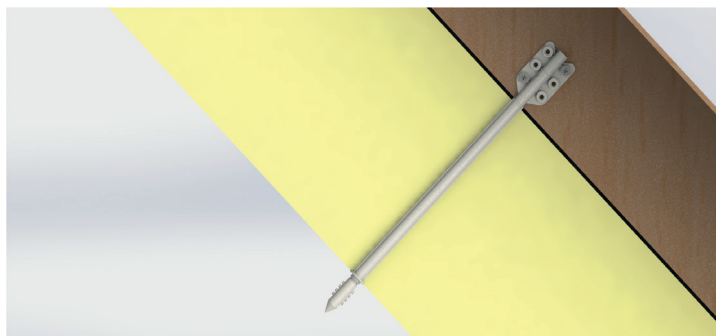
1. Fixer la suspenste sur la charpente
